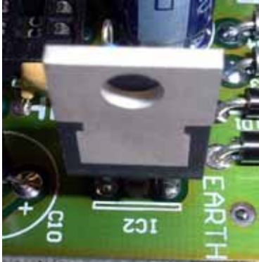
Bild 11 – So sollte IC2 eingelötet werden
