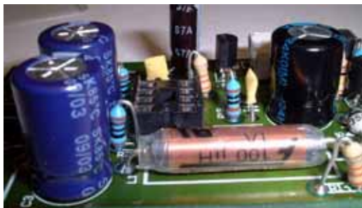
Bild 9 – Korrekter Einbau der großen Kondensatoren
