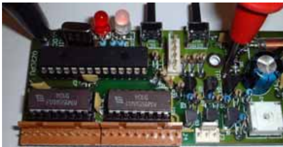
Bild 14 – Messen der korrekten Spannung und Einstellen der Spannung
