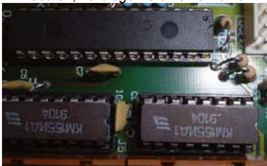
Bild 13 – Korrektes Einsetzen der ICs
